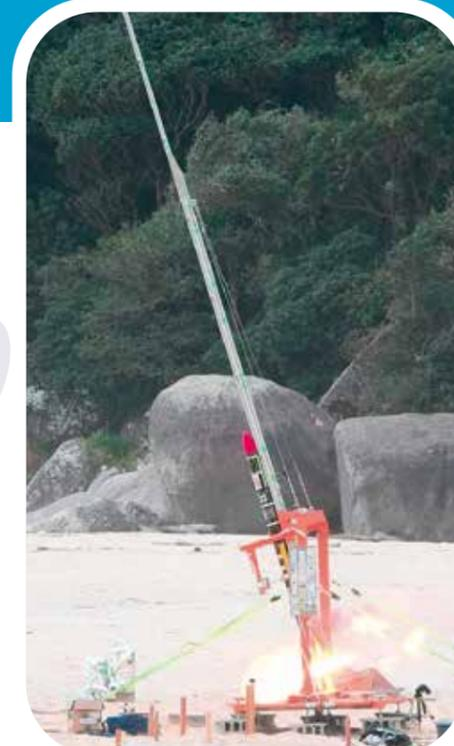
「鹿児島ロケット」5号機は全長2.6m、直径14cm、重さ20kg。衛星利用測位システム(GPS)受信機を搭載し、位置情報や飛行時の各種データの取得も行った。
