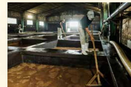
天然の風味を生かす屋内開放型のタンクで、醤油の元となるもろみを発酵する様子
