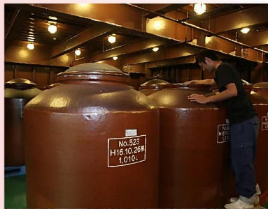
采用 1200 度高温烧制的素烧陶瓮发酵
