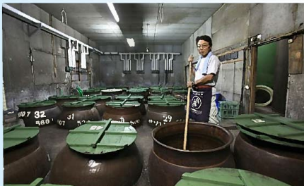
一次下料和二次下料都在这个釜釜中完成
