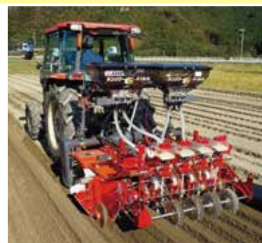
直播作業機での作業
