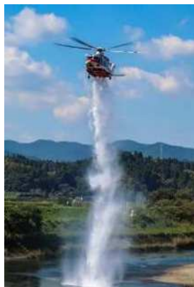
消火タンク（ドロップタンク）による空中消火
