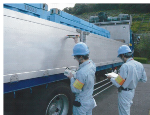
放射線量の測定状況
