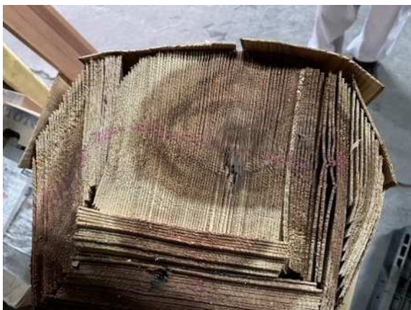
写真6 平木張りの材料および施工事例
