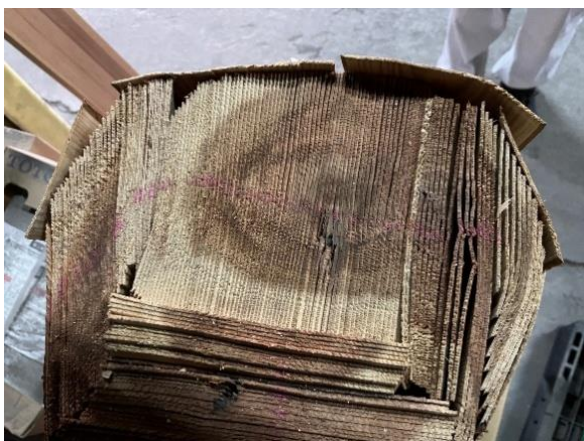
写真6 平木張りの材料および施工事例
