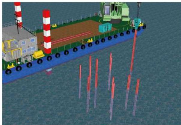
橋脚を支える基礎となる『鋼管矢板』を海底地盤に鉛直に正確に打ち込むため、仮杭を打ち込みます。
