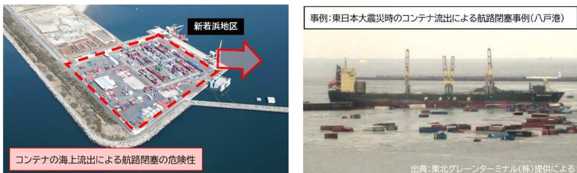
図 5-18 コンテナの海上流出による航路閉塞のリスクと事例
