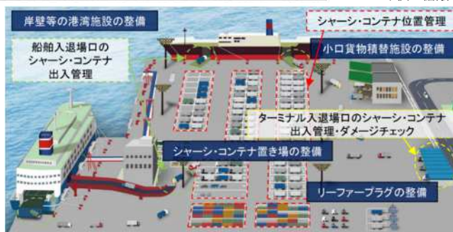
図 6-10 フェリー・RORO 機能の移転候補地と次世代高規格ユニットロードターミナルのイメージ
