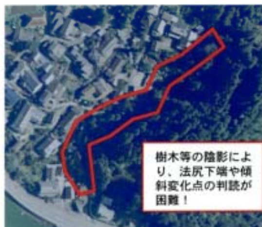
写真地図を活用した危険箇所の抽出
