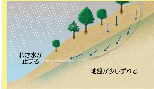
③水を含んだ土の重みと水の圧力で、山が一気に崩れます。
