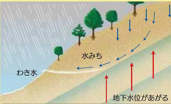
②地下水位が上がることによって、安定していた地盤が動きやすくなり、少しずつずれはじめます。
