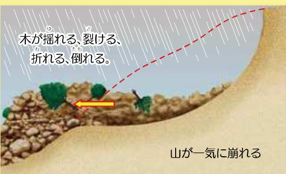
④崩れた土砂は、大量の水と混ざり、一気に下流へ向かって流れています。
