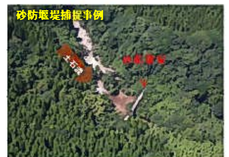
砂防堰堤捕捉事例 始良市平松地内 城瀬川2 土石流
