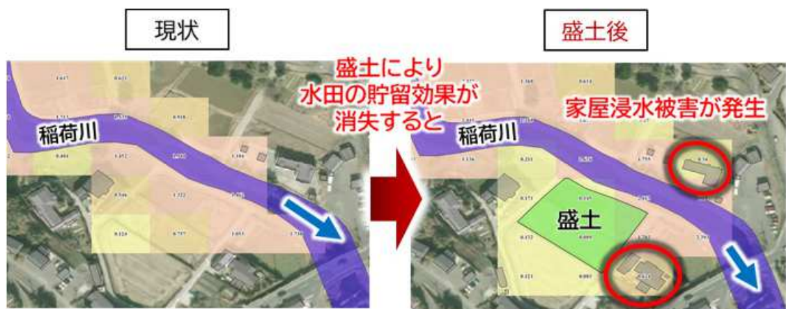
図42 水田への盛土に伴う氾濫形態の変化の例 ( W=1/10 でのシミュレーション結果)
