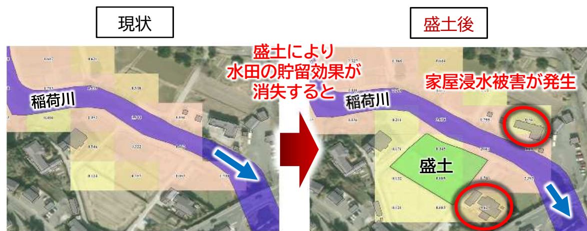
水田への盛土に伴う氾濫形態の変化の例 ( W=1/10 でのシミュレーション結果)
