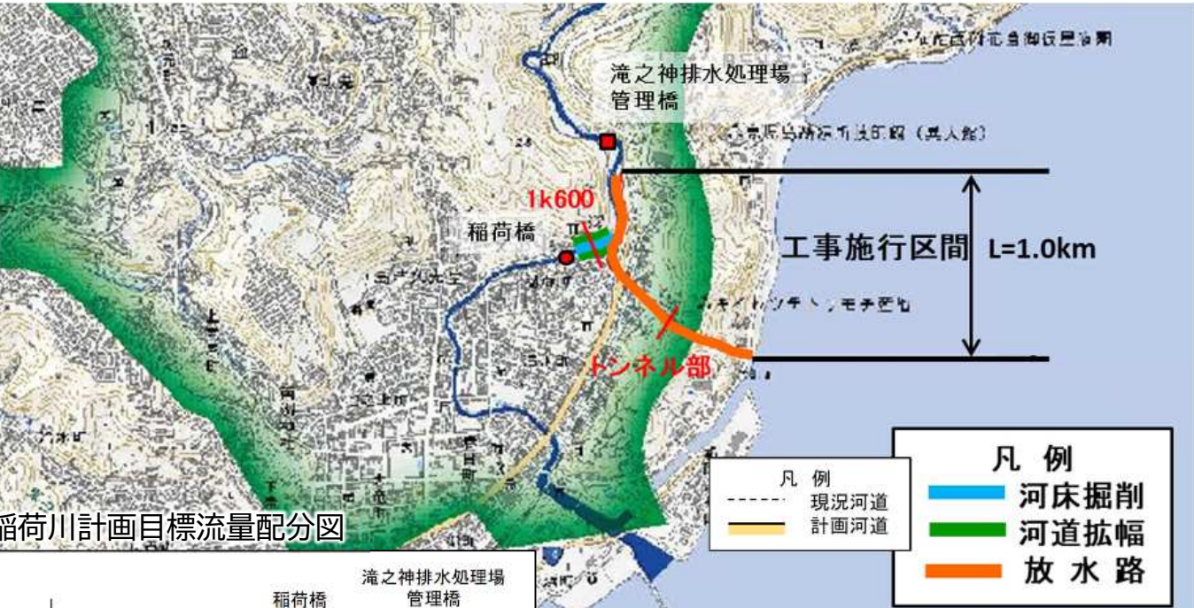
河川工事の施行の場所
