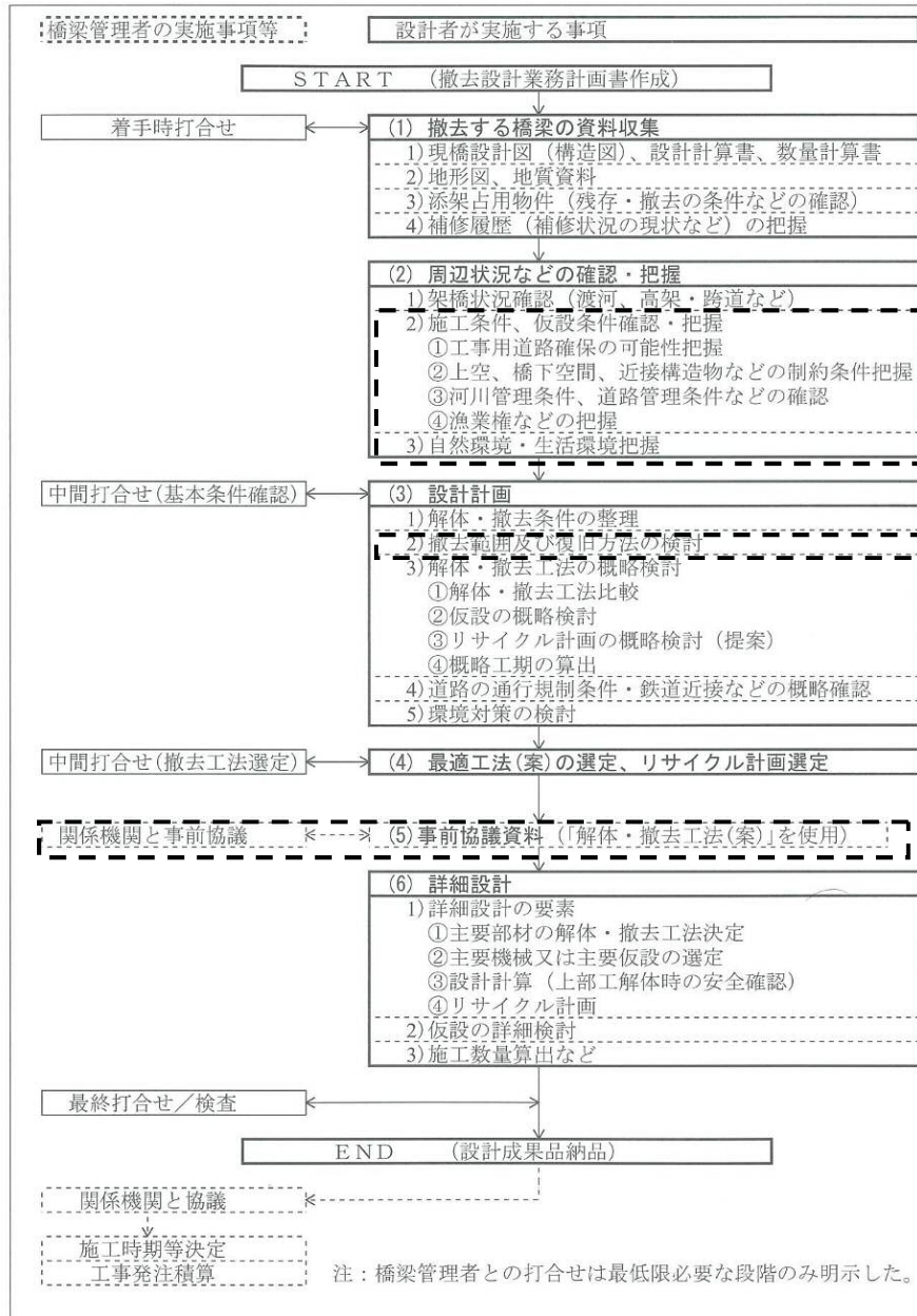
図 4.5.10-1 橋梁撤去の基本フロー
