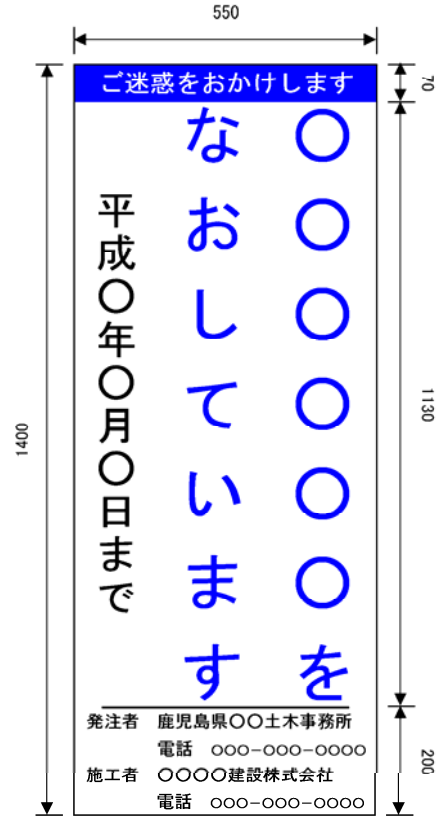
様式 - 7 工事説明看板
