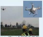
UAV等による写真測量等 により、短時間で面的(高 精度) な3次元測量を実 施。
