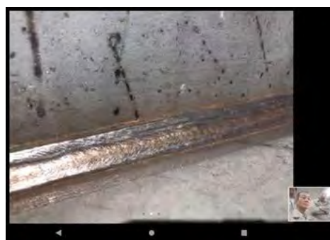
【溶接の仕上がり】 静止して寄れば確認可能だが 移動しながらの確認は映像では難しい
