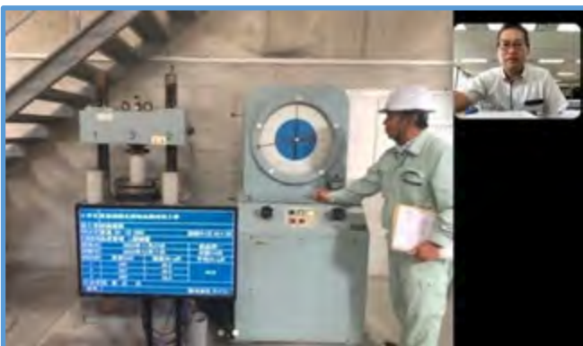
【圧縮強度試験 立会状況（工場側）】
