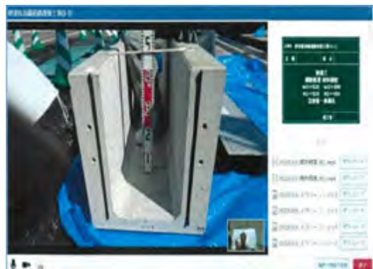
【横断側溝材料検収】
