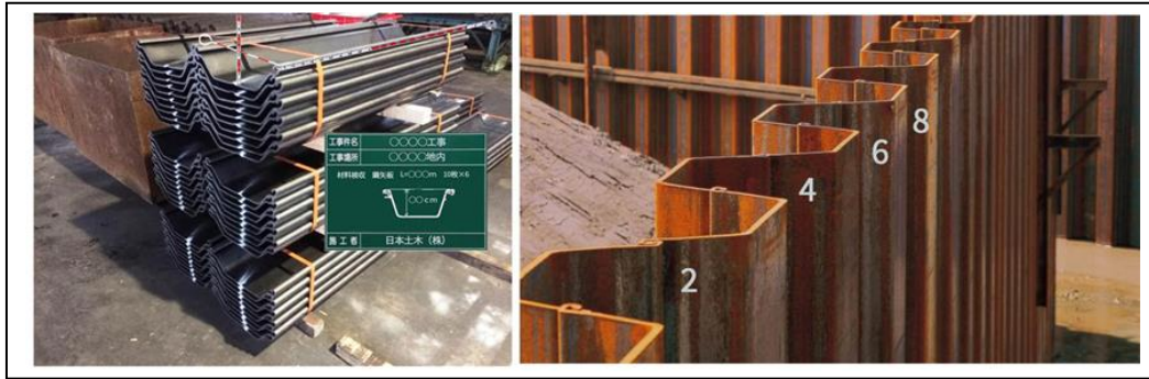
(写真Ⅱ-1) 鋼矢板使用材料写真の例
