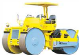
②マカダムローラ 1次転圧
