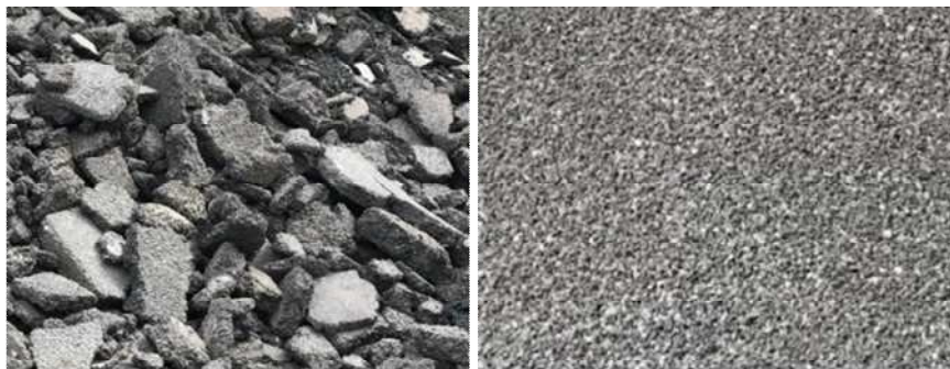
アスファルト舗装の廃材
