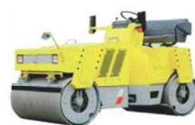
④タンデムローラ 仕上げ転圧
