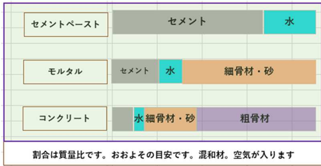
図6 セメントペースト・モルタル・コンクリートの構成
