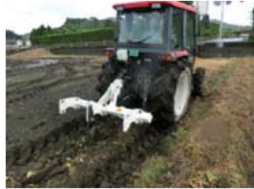
図9 プラソイラによる耕盤破碎
