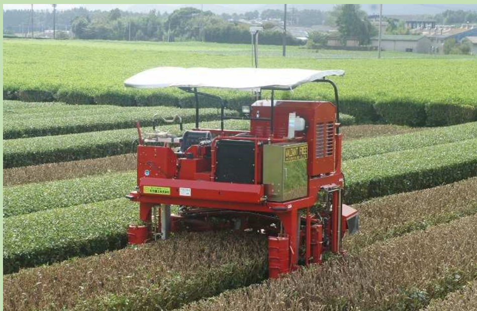
ロボット中切機による管理
