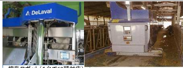
搾乳ロボット(1台で60頭対応)
