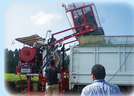
【遠隔操作で機体に乗らずに安全に作業】
