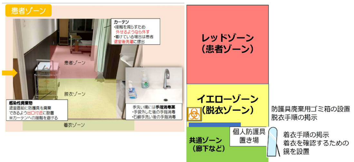
図. 個室単位でのゾーニング (左図は鹿児島大学病院 感染対策マニュアル 接触予防策から引用)
