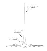
ドキシサイクリン (0.01μg/mL) の例 図3 カラム温度及びカラムによる
