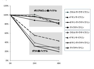
図4 バイアルによるピーク面積の変化
