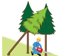
(図3)かかっている立木の伐倒
