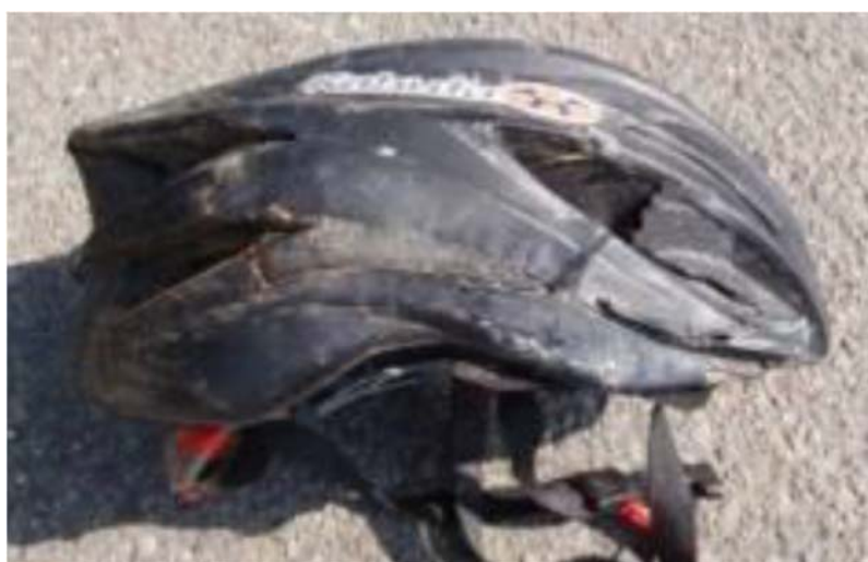
図 20 自転車・ヘルメットの損傷状況
