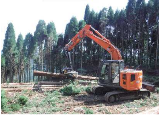
【高性能林業機械（プロセッサ）】
