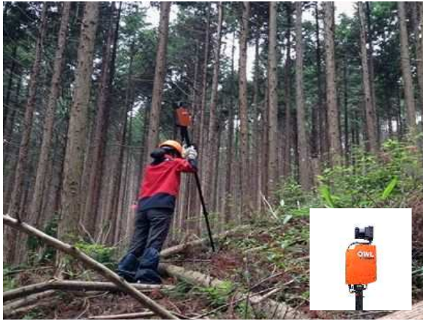
地上レーザー計測器による資源調査 (森林資源調査イノベーション推進事業)
