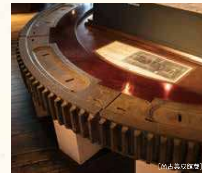
工場の動力には蒸気機関が用いられた。形削盤など場内の機械に動力を伝えていた大きな歯車が館中央に展示されている。
