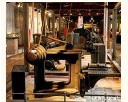
工場の動力には蒸気機関が用いられた。形削盤など場内の機械に動力を伝えていた大きな歯車が館中央に展示されている。
