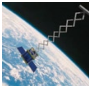
▲開発中の鹿児島人工衛星イメージ。太陽電池パネル2枚、送受信機、コンピュータ、カメラ、姿勢安定ブームなどを装備。
