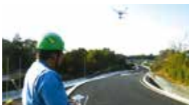
ドローンによる撮影撮影した写真から、地形の形状などを測量する
