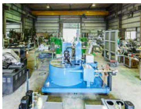
マグネットインラインフィルターに溜まった切粉は、シリンダーを上下するだけで除去でき、掃除時間の短縮につながる。
